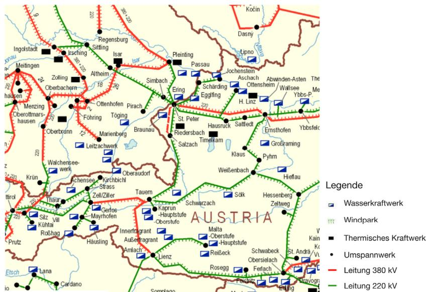
Abb. 11 Höchstspannungsnetz im Raum Salzburg
